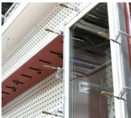
Testovací zařízení pro zatížení tlakem větru
