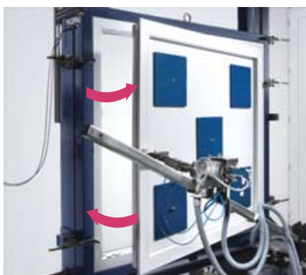
Zkušební stolice okna pro zatížení dobou používání
